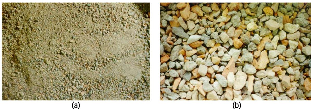
Figura 18 Aspecto geral dos agregados reciclados: a) Agregado miúdo; b) Agregado graúdo
