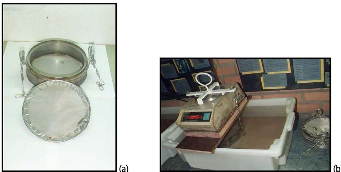
Figura 21 Ensaio de absorção do agregado reciclado: a) Recipiente utilizado para execução do ensaio de absorção; b) Amostra de agregado submersa e balança hidrostática utilizada para efetuar as medidas durante a realização do ensaio.
