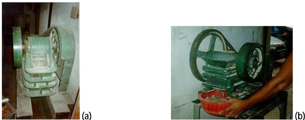
**Figura 15** a) Britador de mandíbulas para produção de agregados com graduações maiores. b) Britador de mandíbulas para produção de agregados de graduações menores
